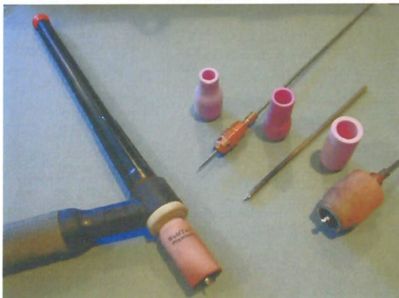
Figura 2.18 – Tocha TIG e detalhe dos seus componentes [24].
