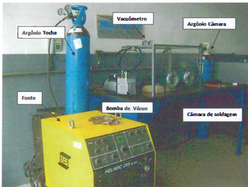
Figura 4.6 – Sistema de soldagem em câmara com atmosfera inerte. Visão geral dos equipamentos e acessórios.
