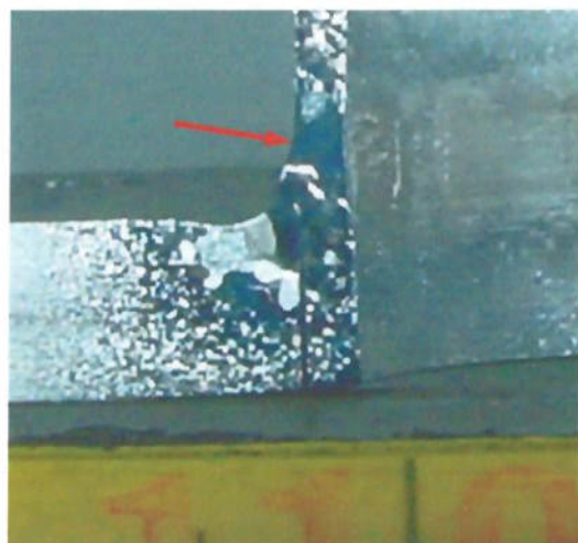
Figura 5.2 – Macrografia da PT-01. Vista ampliada da região da solda. A seta vermelha mostra região monocristalina.
